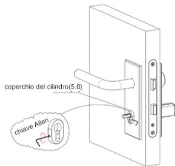
Se il cilindro è troppo lungo, introdurre il coperchio del cilindro tra il pomello interiore e il pannello di sicurezza.
